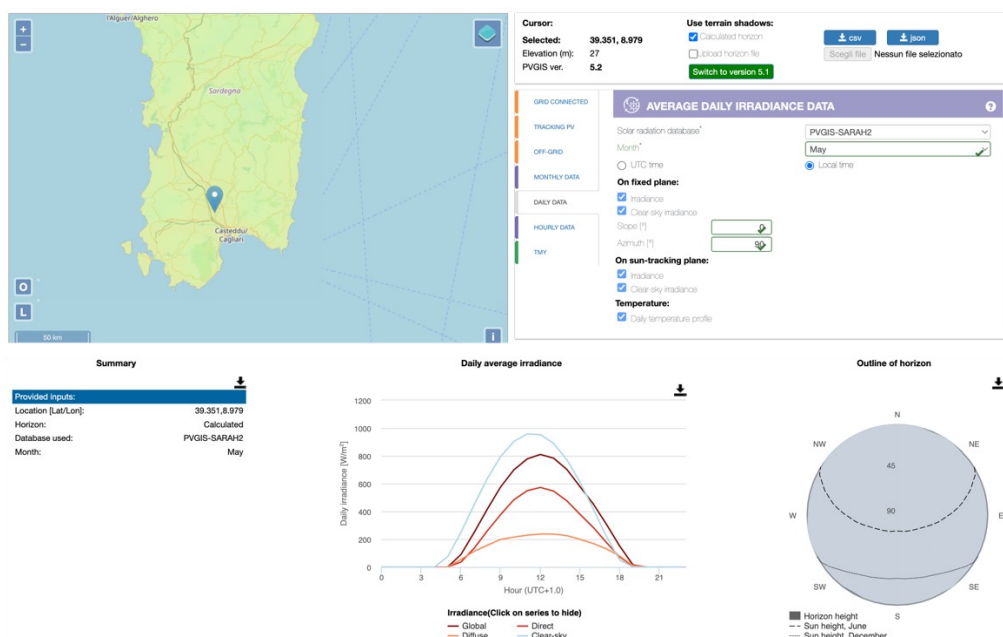
Figura 6 Panoramica sullo strumento impiegato per il calcolo dell'intensità della radiazione solare.
